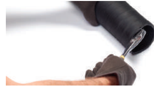
Cable helicoidal doblado en la superficie interna del tubo de la manguera.
