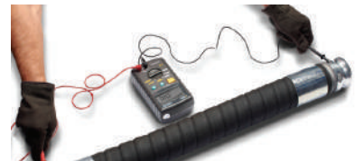
El ensamble de la manguera se está probando con un óhmetro.
