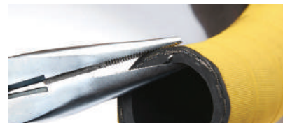
Pellizca la grapa en la pared del tubo.
